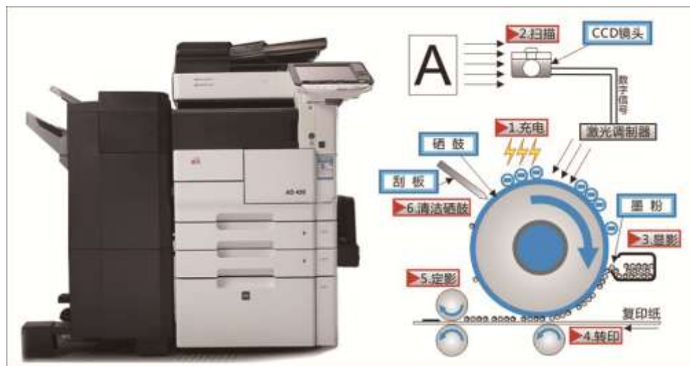
融合扫描仪和激光打印机为一体的数码复印机及其工作原理图
